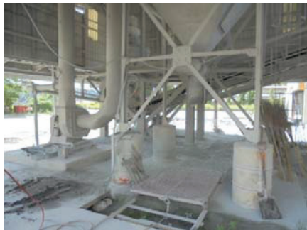
รูปที่ 2-13: การกำจัดฝุ่นแบบระบบถุงกรอง (Bag Filter)
