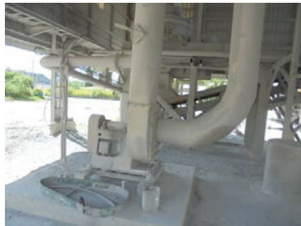
รูปที่ 2-13: การกำจัดฝุ่นแบบระบบถุงกรอง (Bag Filter)
